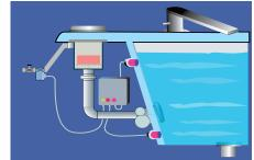
Der obere Wasserpegelfühler ist mit Wasser bedeckt - das Whirlpool ist einsatzbereit.
