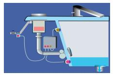
Der untere Wasserpegelfühler signaliesiert der Steuerung den Wasserabfluss. Somit wird das Elektroventil für das S pülleitungswasser geöffnet.
