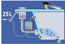
Das durch den Tablettenbehälter fließende Wasser erzeugt eine Lösung, die das System und Düsen durchspült. Alle biologischen Verunreinigungen werden entfernt.
